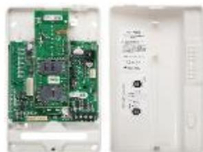
Módulo GPRS/SMS Permite trabajar con dos SIM CARD - Habilita los paneles de control Paradox para la conexión a la nube de Paradox, " Swan Cloud" - Permite el usuario el Armado y desarmado mediante su celular o plataforma web, conexión mediante los paquetes de datos de su CHIP. - Compatible con Magellan, Spectra y Evo.
